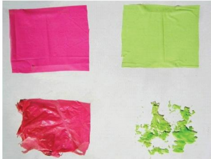
Полиэтиленовые пленки без TDPA® (розовая) и с TDPA® (зеленая), до (вверху) и после (внизу) 10 месяцев захоронения на свалке Великобритании
